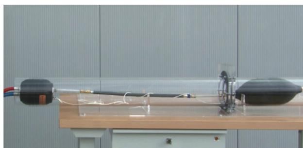
Rohrblasen für Rohre mit größerem Durchmesser PLUGY & PLUGSY
