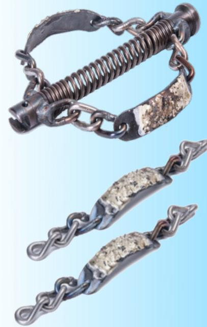
Kettenschleudern – mit Hartmetallsägezähnen besetzt (HSZ)
