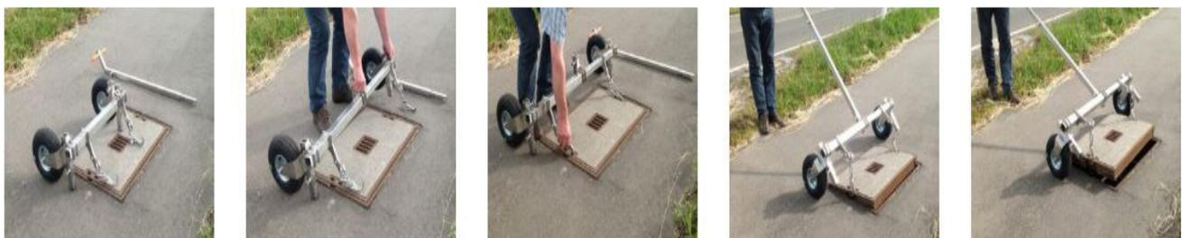
Anwendungsablauf (am Beispiel einer eckigen Schachtabdeckung mit 2 Aufnahmelöchern)
