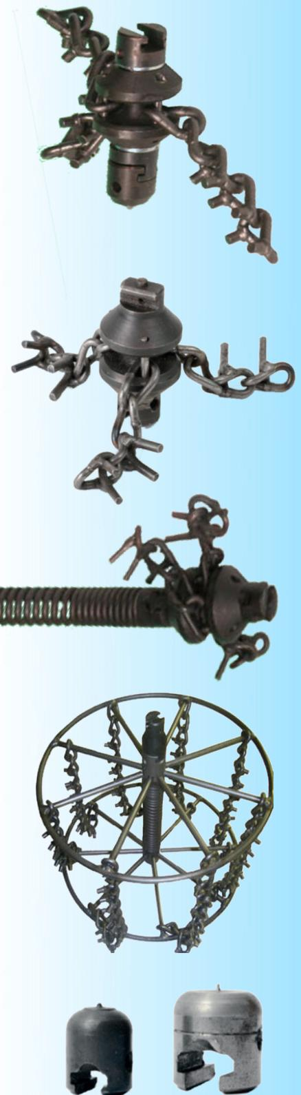
Kettenschleudern – mit Hartmetallspangen besetzt (HMW)
