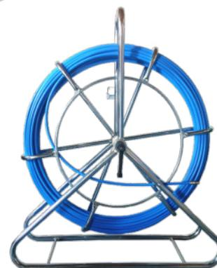
Kabeleinziehgerät mit Glasfaserstab  $\varnothing$  6,0 mm mit PP-Ummantelung, komplett mit Anfangs/Endhülse M6 und Zugkopf M6 mit Öse.
