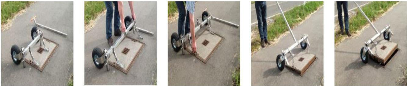
Anwendungsablauf (am Beispiel einer eckigen Schachtabdeckung mit 2 Aufnahmelöchern)
