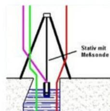
Haltungsprüfung mit Luftüberdruck und Vakuum nach den Prüfnormen EN 1610, DWA M149-6, ATV DVWK-A139, ATV DVWK-A142, Merkblatt 4.3/6 LfW, SIA 190, VSA-Richtlinie, freie Parameter
